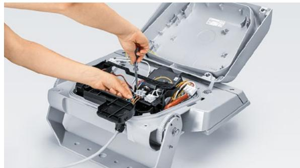
**Schritt 4:** Führen Sie das Kabel durch die Kabelverschraubung in die Leuchte ein und stecken Sie den Stecker in die Buchse.
